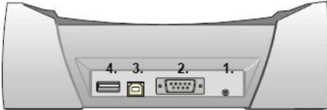
1. Stromversorgung der Kommunikationsstation zum Anschließen des Netzteils HW 1430
